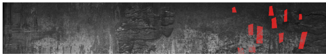
Figura 1: Chapa de aço com seus defeitos destacados.
